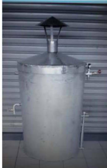
Gambar 2. Ketel uap setelah dirakit
