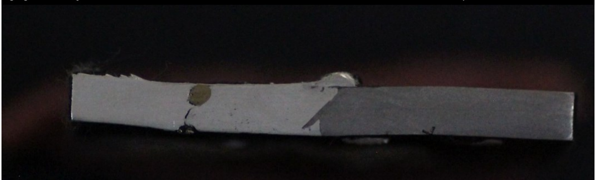
Gambar 2. Foto makro penampang sambungan FSW Al 7075-SS400 pada variasi offset tool : (a) 0,8 mm, (b) 1,2 mm, dan (c) 1,6 mm. Arah kiri menunjukkan Al 7075 dan arah kanan menunjukkan SS400.
